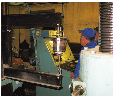
Рисунок П6 Испытательная машина для измерения величины адгезии
