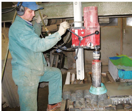
Рисунок П5 Высверливание сэндвич образцов – кернах, содержащих бетонное основание и ремонтный состав
