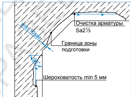
Узел А (III этап. Ремонт)
